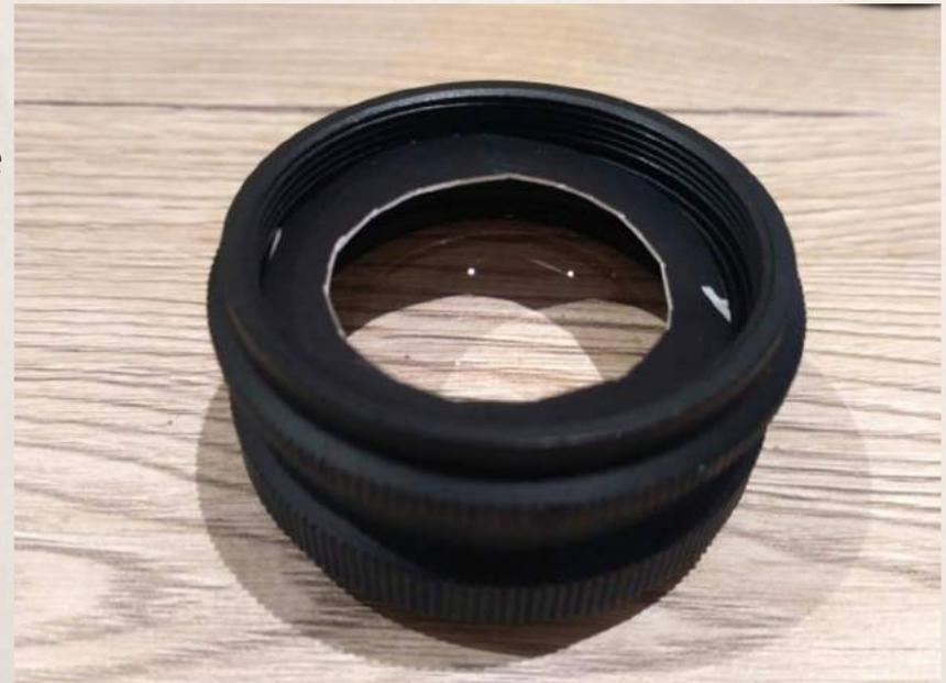
Diaphragme 3.5 à 4 en carton inséré dans le tube m42 devant le verre.
