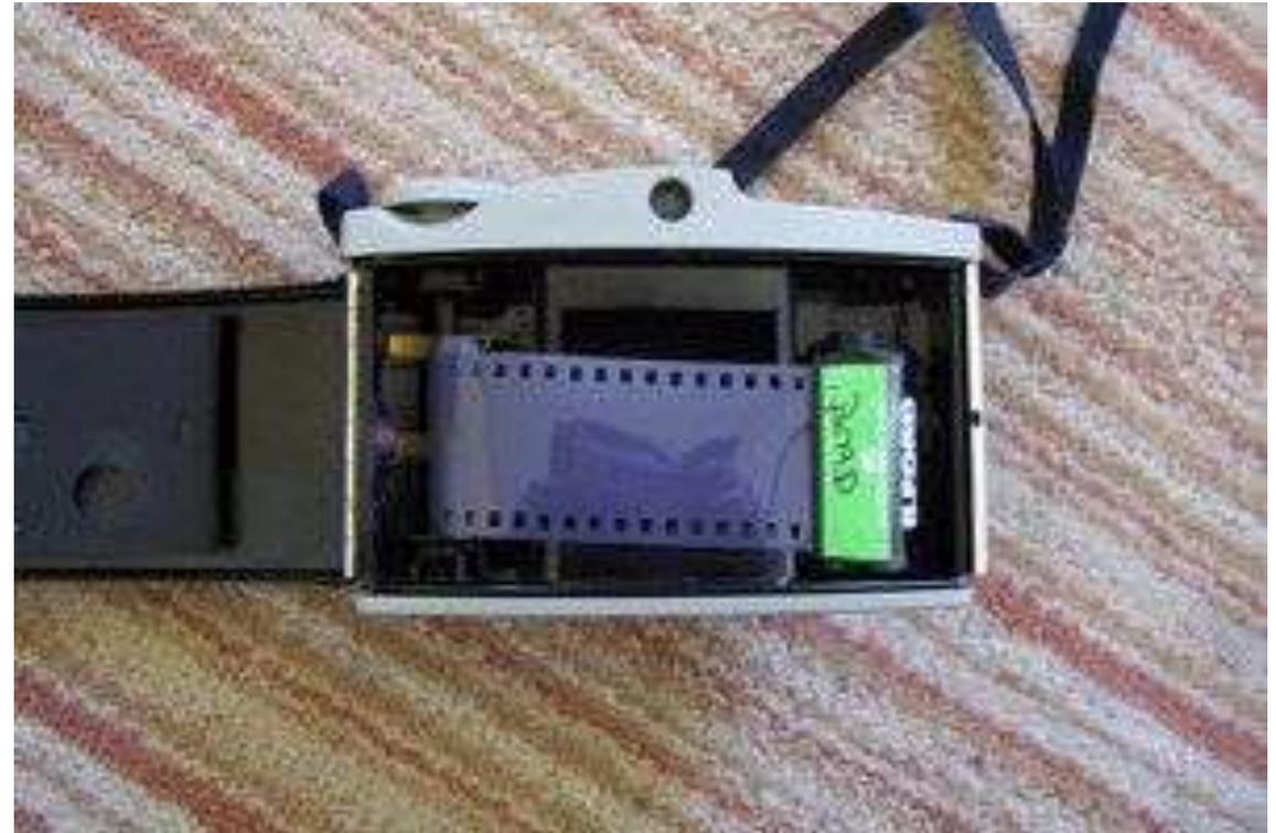
Le boîtier est choisi. Maintenant comment mettre le film en place? Le plus simple serait d'y aller et de caler l'amorce du film dans la bobine réceptrice mais alors, il y aurait une perte de film le temps d'avancer jusqu'à la première vue. Solution: je récupère le papier de protection d'un film 120 déjà développé. Le scotch qui maintient le film permet de voir facilement où scotcher l'amorce.
