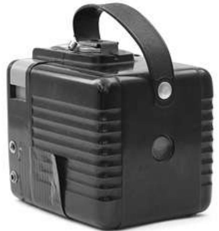
Il y a deux vis cruciforme pour démonter l'intérieur, le ménisque est sur un support plastique, ça prend 5 minutes.
