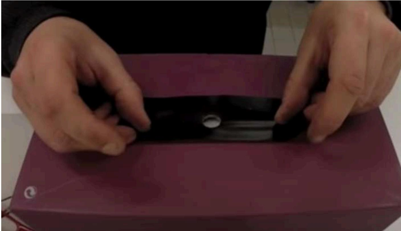
**6. Placer un « tape » noir devant le trou directement sur le papier d'aluminium. \*Ce « tape » doit couvrir tout le papier d'aluminium.**
