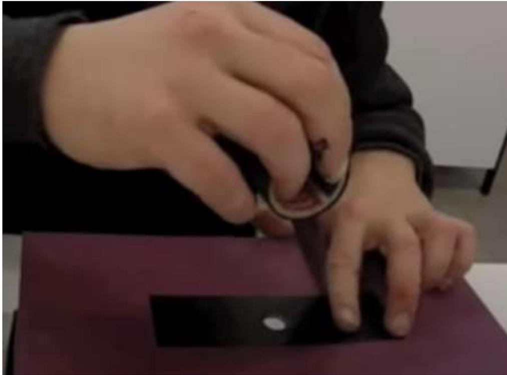
**La fonction de ce « tape » servira d'obturateur.** Ainsi, il va permettre de faire entrer la lumière dans la boîte MANUELLEMENT lors de la prise de vue ou de bloquer la lumière si la prise de vue est terminée.
