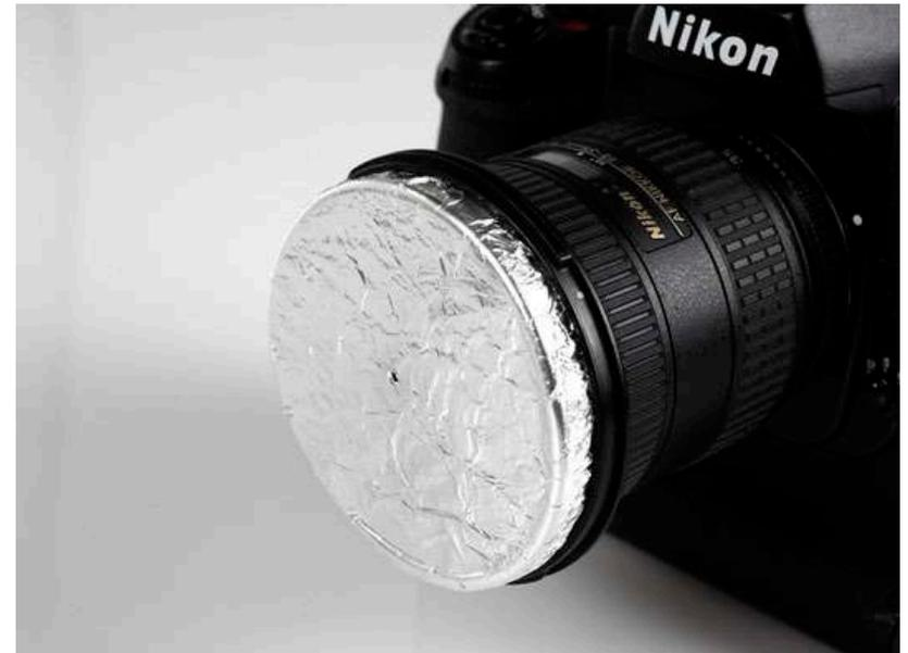
Ne cherchant pas trop de précision, Chaignon a essayé divers matériaux pour percer le trou **qui allait remplacer l'objectif de la classique canette d'aluminium. La solution : un morceau de carton** en passant par la bande magnétique d'un ticket de métro. **Il préfère cela, car les fibres de carton forment un trou irrégulier et imparfait.**
