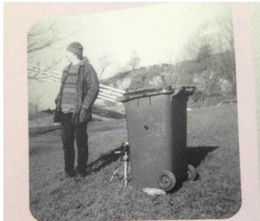
*ci-dessus* : Justin Quinnell et sa « poubelle à roulettes » à sténopé panoramique. Le papier photo est chargé en chambre noire à l'abri de la lumière, puis le couvercle est rendu opaque avec de l'isolant électrique noir. Le sténopé est un trou de 2 mm percé dans l'aluminium, qui est placé au-dessus d'un trou plus large au milieu de la poubelle. Un petit morceau d'isolant noir sert d'obturateur.
